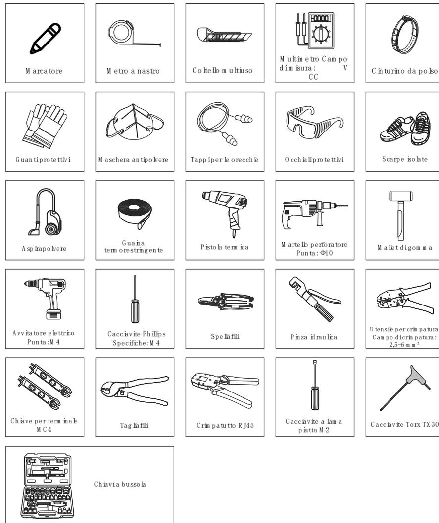
Figure 4.5. Strumenti di installazione consigliati
