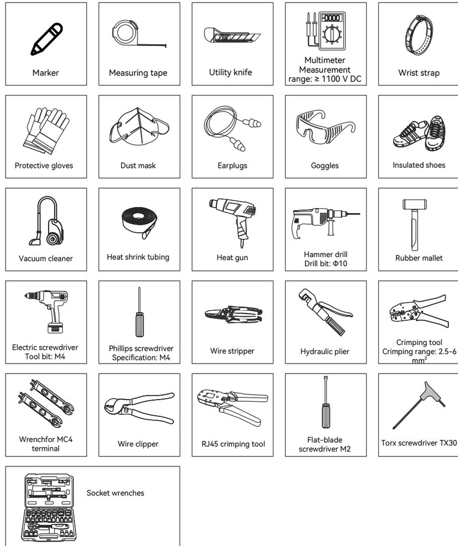
Figure 4.6. Herramientas de instalación sugeridas
