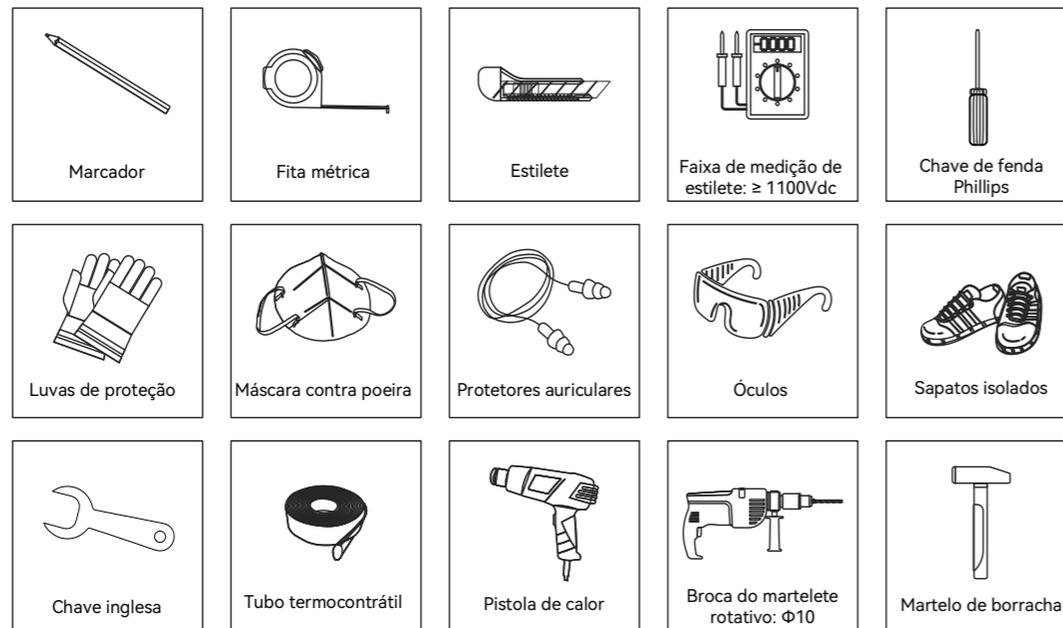
Figura 3.2. Ferramentas de instalação sugeridas
